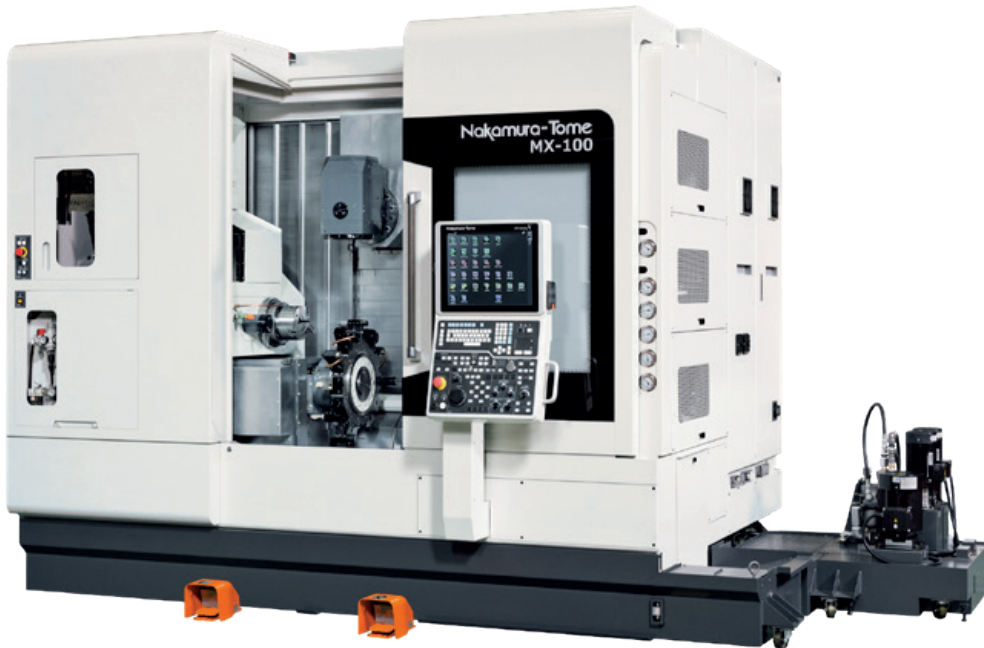
MX-100: Máquina multitarea CNC con husillos gemelos opuestos
