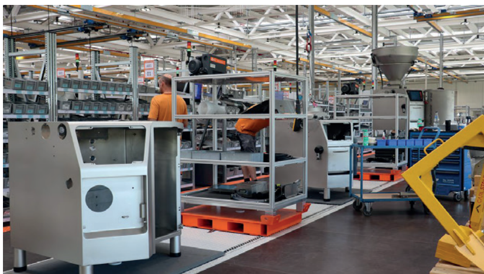
En la línea de transporte, se sitúan de manera alterna placas de transporte con el bastidor de la máquina y carros de set
