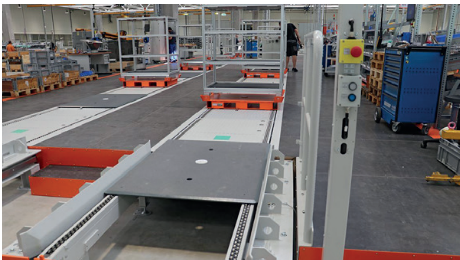
Un elemento importante del sistema de transporte es la placa portante, cuyo diseño, de KNOLL, permite transportar cualquier bastidor de máquina
