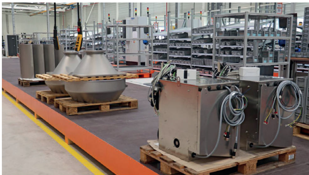
Los llamados carros de set desempeñan una función esencial transportando también componentes específicos del pedido para cada máquina que se está montando
