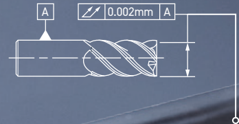
MENOS DE 0,002 MM DE SALTO EN EL FILO DE CORTE CON REFERENCIA AL MANGO
