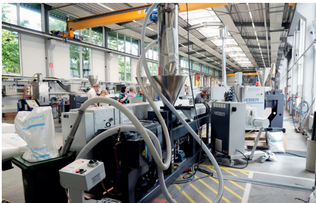
Weber presentó en su planta piloto de Kronach una línea de extrusión de alto rendimiento para la producción de tubos de PE-RT de 5 capas con una capa de barrera al oxígeno
