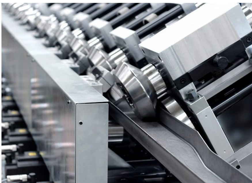
La posibilidad de producir perfiles de sección variable con líneas perfiladoras automáticas ofrece enormes beneficios en términos de flexibilidad, calidad del producto acabado y reducción de los costes
