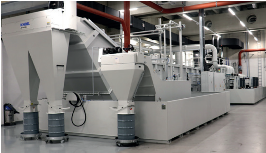
Perspectiva de crecimiento: la instalación MicroPur® de Knoll para la filtración de aceite puede ampliarse hasta una capacidad de 10.000 l/min
