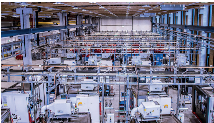
Vista de una de las nuevas naves de producción de Kreckelmoos, donde se rectifican plaquitas intercambiables de metal duro; en las rectificadoras hay estaciones elevadoras de Knoll que bombean el líquido por el techo hasta la instalación de limpieza
