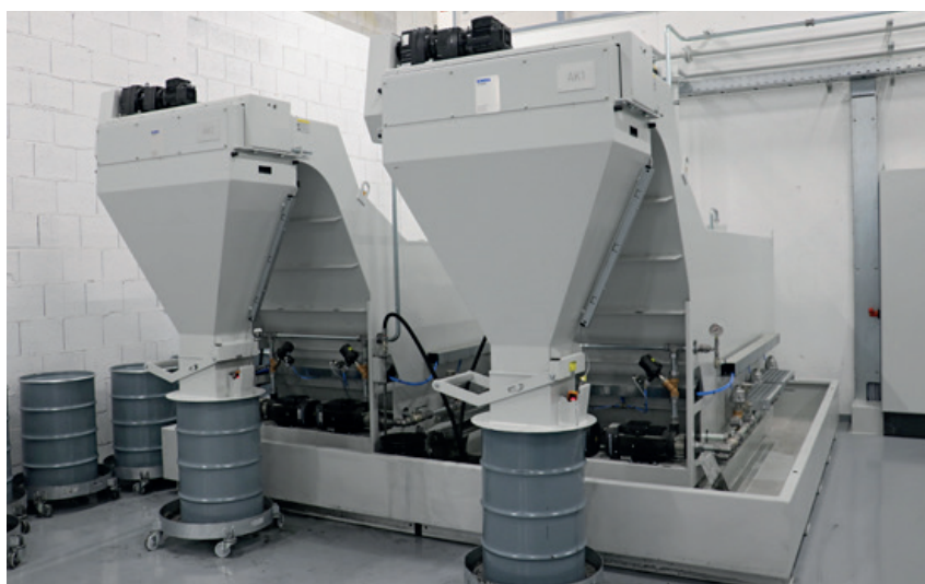
Un componente importante de las instalaciones de filtración Knoll es el concentrador automático integrado, que garantiza que el lodo de metales duros acabe en el bidón de eliminación a prueba de pinchazos
