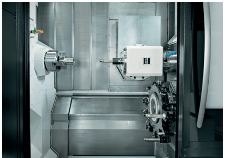
El cabezal fresador con cambiador de herramientas de menor tamaño del mundo en su clase, "NT Smart Cube", permite una utilización más eficaz de la amplia área de mecanizado de la JX-200
